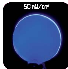
Диск з оксиду цирконію товщиною 0.4 мм, що покритий шаром кераміки товщиною до 1.6 мм.
