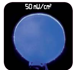
Диск з кераміки (e.Max ® ) товщиною 0.5 мм, який покритий шаром кераміки товщиною до 1.5 мм.
